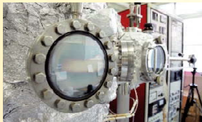
分子線エピタキシー装置 MBE equipment
