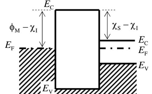
1 - 1 金属に正の電圧を印加した場合のエネルギーバンド図を描け。
