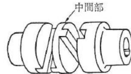
図 3・33 オルダム軸継手
