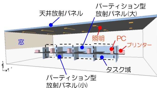
天井とパーティションに冷水を流す放射冷房システムを導入したオフィスモデル室にて、人が作業するタスク域の平均PMV<sub>avg</sub>をある快適値に保つようにフィードバック計算を行い、冷凍機の理論動力を算出した。
