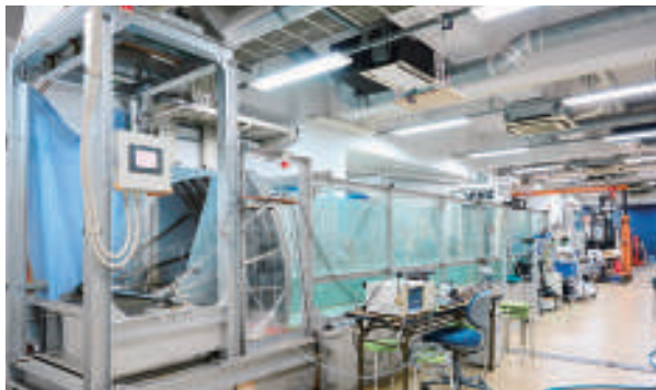
モデル実験(崩壊した水門の1/13スケール)
